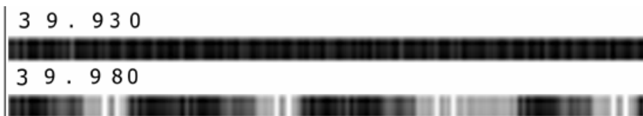
図 37：正確なピッチ（上）と不正確なピッチ（下）
