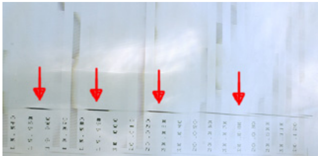
図 32：未補正の印刷物の破線状の補正ライン
